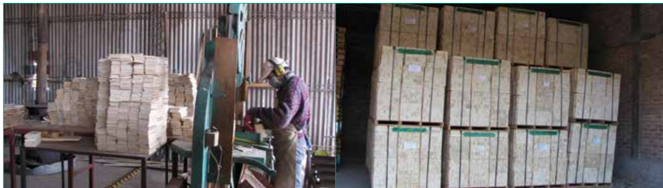
Figura 39. Fabricación de tablitas para lápices: operario cortando las tablas (izquierda) y material preparado para la exportación (derecha) (Mendoza).
